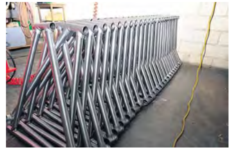
Für den Rahmen werden Chrom-Molybdän-Rohre benützt. Foto: Firma Aarios
